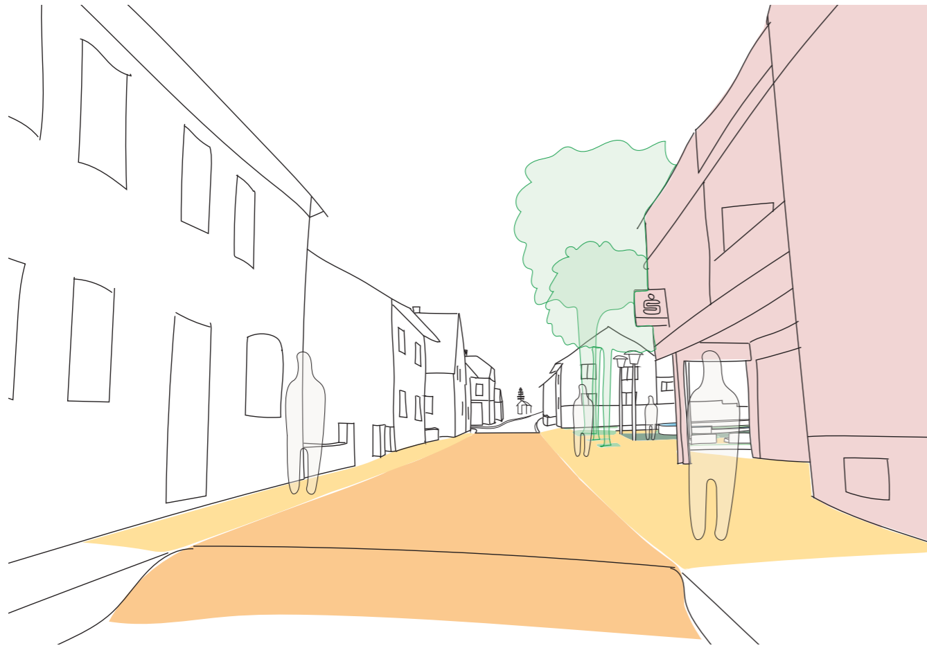
Abb. 33: Angehobene Fahrbahn mit Anrampung in der Hauptstraße aus Richtung Süd-Ost
